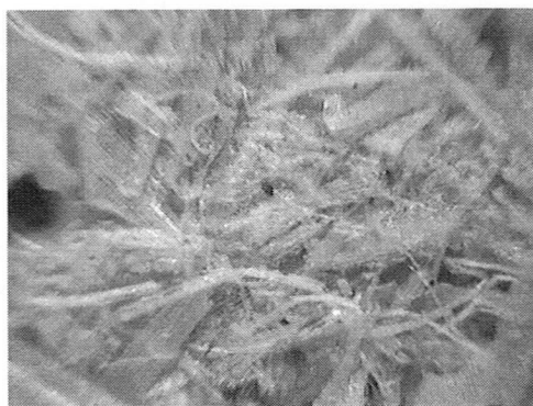
Zdjęcie 2. Masa włóknista wytworzona ze słomy pszenżytniej w warunkach laboratoryjnych – powiększenie 25x
