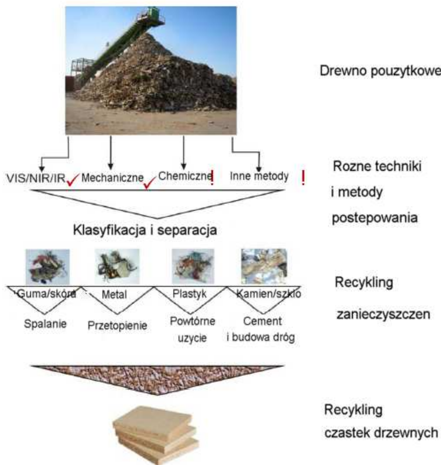
Rys. 1. Kompleksowy sposób oczyszczania drewna użytkowego VIS – spektrofotometria w zakresie światła widzialnego, NIR – bliska podczerwień, IR – podczerwień
