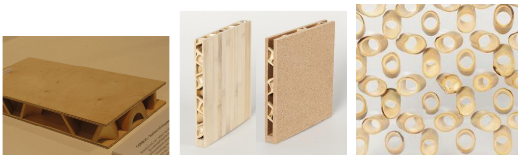
Rys. 5. Przykłady elementów płytowych CONBOU ze rdzeniem wykonanym z fragmentów pędów bambusa i różnymi okładzinami typu sklejka, cienka płyta stolarska z litego drewna, płyta wiórowa, szkło organiczne (fot. z lewej, M. Grześkiewicz, pozostałe ze strony www.conbou.de )
