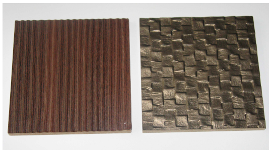
Rys. 2. Płyta HDF z serii Motion oklejona mikrookleiną i z wytłaczanym termicznie wzorem na powierzchni (fot. M. Grześkiewicz)
