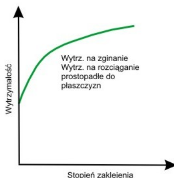
Rys. 2. Wpływ stopnia zaklejenia na parametry wytrzymałościowe płyt wiórowych (Niemz 1993)
