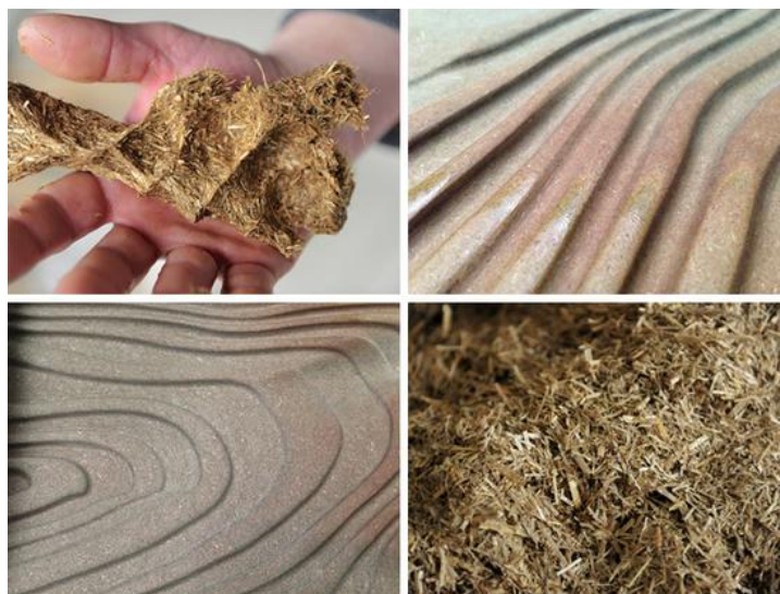
Rys. 9. Materiał w postaci cząstek słomy zbożowej i przykładowe płyty HOS z głęboką fakturą otrzymane z tego materiału (źródło: www.zadtatech.ch )
