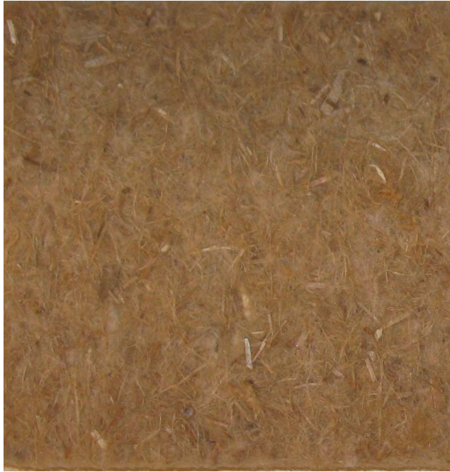
Rys. 8. Fragment tworzywa o handlowej nazwie NAPRO NATcoustic z cząstek pałki wodnej, z włóknami poliestrowymi i niewielkim dodatkiem żywicy, wykorzystywanego jako izolacja ciepłno-akustyczna, alternatywa dla wełny mineralnej (fot. M. Grześkiewicz)
