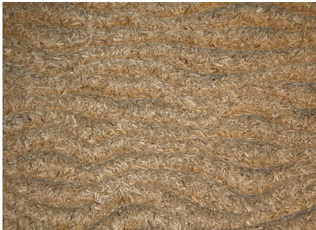
Rys. 13. Widok powierzchni 3D ACOUSTIC PANEL wykonanej z cząstek konopi (fot. M. Grześkiewicz)
