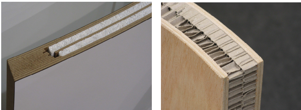
Rys. 4. Przykłady lekkich konstrukcji skorupowych. Gięto-klejone arkusze cienkiego MDF z wkładem w postaci dwóch formatek cienkiego, spienionego polistyrenu (z lewej) i skorupa z okładzinami ze sklejki elastycznej i wypełnieniem w postaci dwóch warstw papierowego plastra miodu (z prawej), (fot. M. Grześkiewicz)
