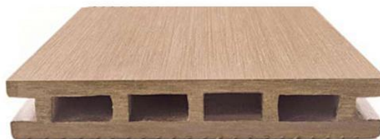
Rys. 7. Element wytłaczany z materiału kompozytowego o handlowej nazwie RESYSTA, w którego skład wchodzi łuski ryżu, chlorek sodu i olej mineralny. Elementy tego typu wykorzystywane są w konstrukcjach tarasów (fot. ze strony www.resysta.com )
