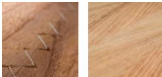
Rys. 3. Połączenia fornirów wzdłuż włókien – z wykorzystaniem nitki klejowej (z lewej) i kleju termo topliwego (z prawej) (KUPER – Katalog Produktów)
