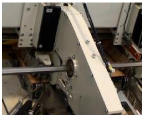
Rys. 12. Ruchome dysze zapewniające naprzemienny system przebiegu nici klejowej (KUPER DMF 1800 – materiały filmowe).
