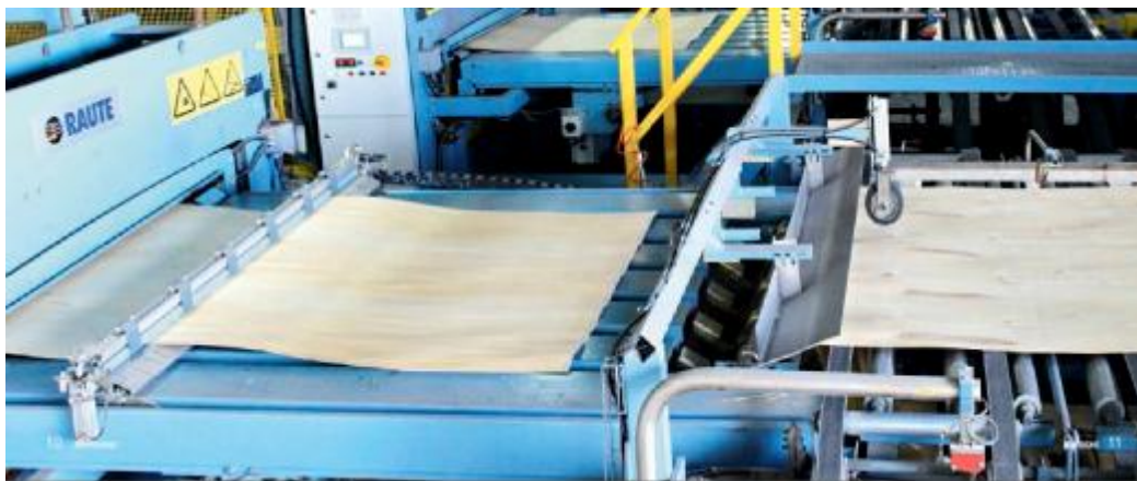
Rys. 17. Prasa do łączenia arkuszy fornirów na długość (Zhdanov 2014)
