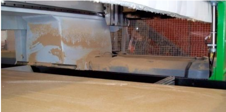
Ryc.4. Pył osiadły na elementach konstrukcji obrabiarki
