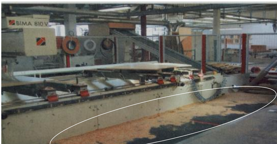
Ryc.7. Zapylenie miejsca pracy obrabiarki CNC po obróbce zaledwie kilku płyt wiórowych
