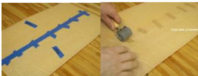
Rys. 6. Łączenie fornirów z wykorzystaniem taśm papierowych
