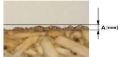
Rys. 17. Sposób wyznaczania wskaźnika jakości obróbki A
