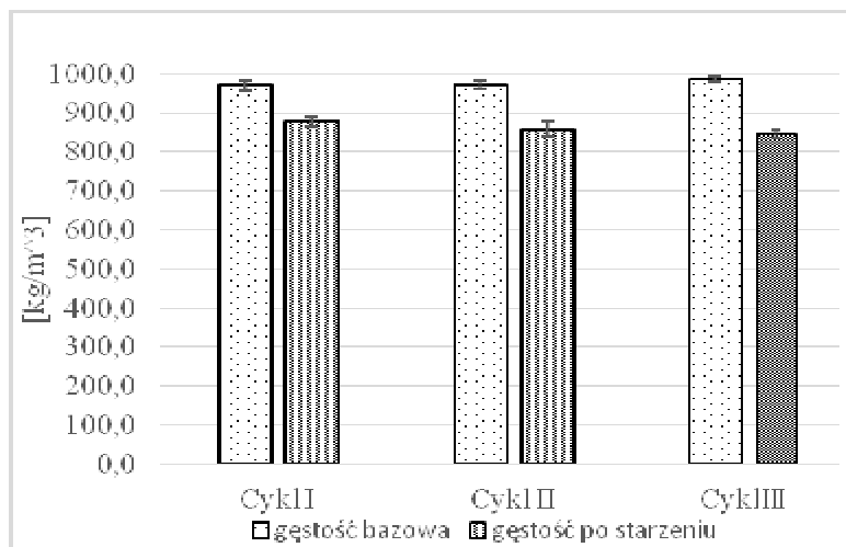
Rys.1. Gęstość bazowych płyt HB i po cyklach starzenia
