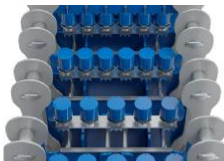
Siłowniki ram prasy homogenizujące powierzchnię produkowanych płyt
