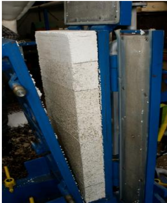
Fot nr 2: Jednoczesne spienienie różnych wariantów wytwarzanych próbek
