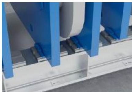
System Równoległej Szczeliny Prasy zapewnia minimalne różnice szczeliny między siłownikami ram
