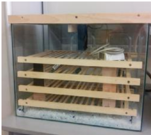
Ryc. 3. Stanowisko o parametrach powietrza 23°C i 0% wilgotności względnej powietrza do ustalenia parametrów po suszeniu w temp. 105°C
