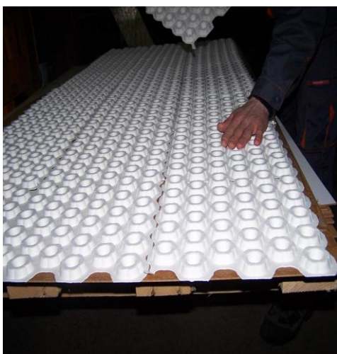
Fot 2. Okładzina MDF z warstwą wkładu EcoPlank
