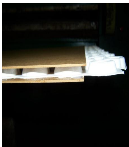
Fot 3. Płyta z wkładem EcoPlank
