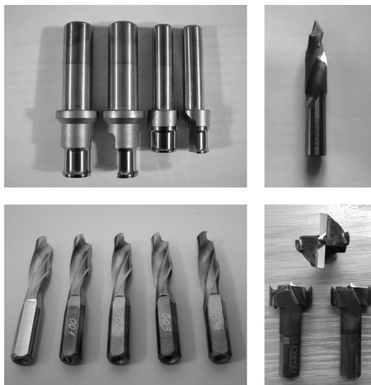
Rys. 12. Przykłady noży kształtowych i wiertel Fig. 12. Examples of the profile cutters and the drills
