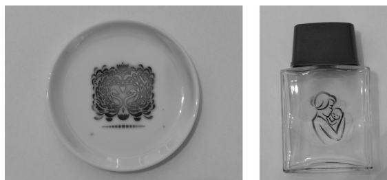
Rys. 3. Przykład zdobienia przedmiotów metodą implantacji jonów Fig. 3. Example of decoration using the ion implantation method
