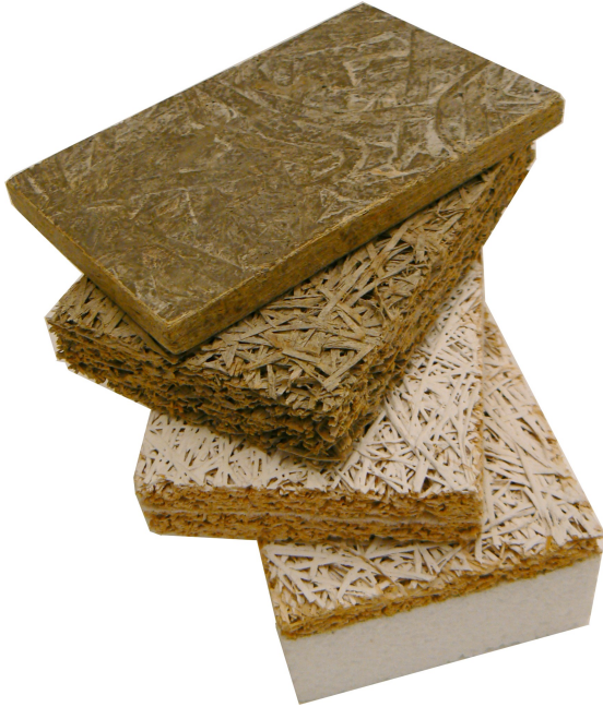
Rys. 7. Różne warianty płyt cementowo-wiórowych firmy Eltomation B.V. (17) (fot. P. Borysiuk).
