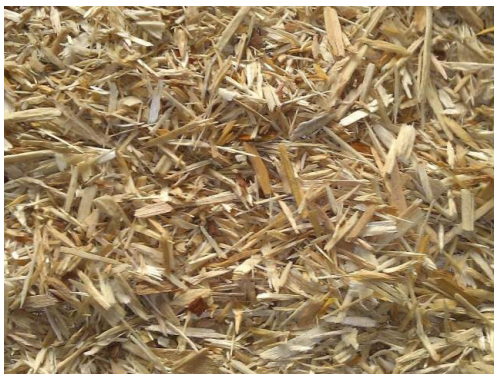
Fot. 5. Wióry warstwy wewnętrznej
