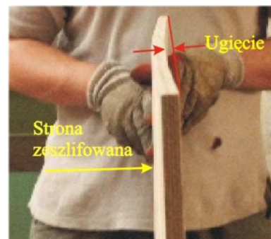
Rys. 17. Odkształcenia sklejkі wywołane nie równomiernym zeszlifowaniem (Szmygiel 2003)
