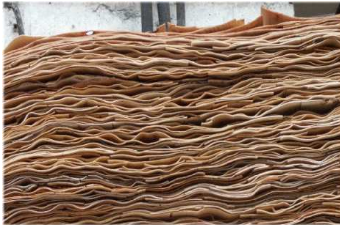
Rys. 6. Pofałdowanie forniru po suszeniu (Szmygiel 2003)
