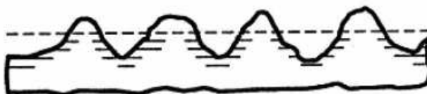
Rys. 8. Zmniejszenie chropowatości po procesie szlifowania (Białecki i in.2008)
