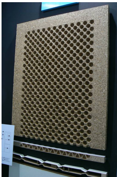
Rys. 18. Płyta wiórowa wytłaczana wytworzona w technologii firmy Biele ( fol. P. Borysiuk )
