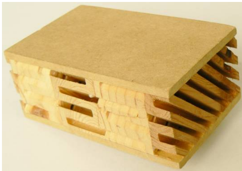
Rys. 17. Przykłady płyt komórkowych o różnych wypełnieniach ( fol. P. Borysiuk ): a) papier „plaster miodu”, b) układ ustawionych „na sztorc” płyt HDF, c) tworzywo Dendrolight
