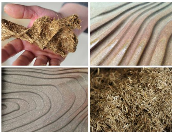
Rys. 14. Materiał HOS i przykłady możliwości jego formowania (15)
