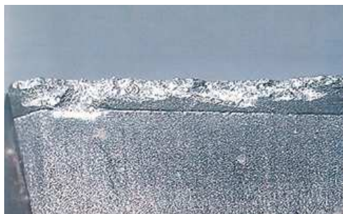
Rys.11. Wykruszenia ostrza z diamentu polikrystalicznego w wyniku kolizji z zanieczyszczeniami mineralnymi płyty wiórowej
