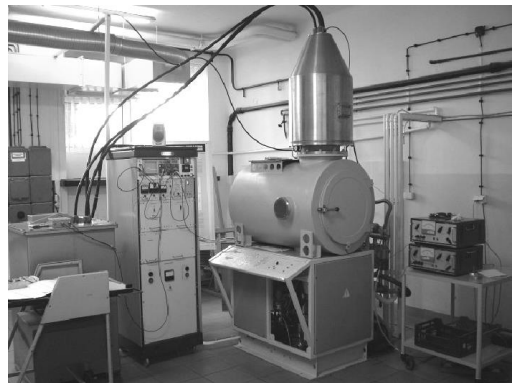
Rys. 2. Implantator jonów typu MEVVA Fig. 2. MEVVA type ion implanter
