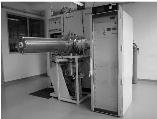
Rys. 3. Generator impulsów elektronowych Fig. 3. Pulse electron beam device
