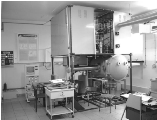
Rys. 1. Implantator jonów gazowych Fig. 1. Gas ion implanter
