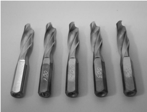
Rys. 5. Wiertła ze stali szybkotnącej Leitz Fig. 5. High-speed steel drills
