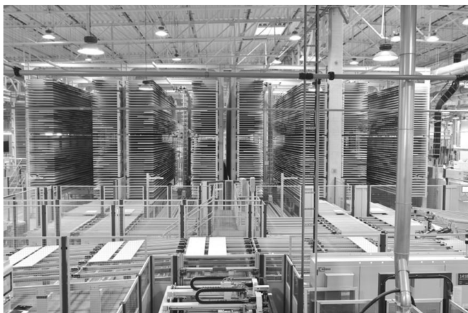
Rys. 3. Linia produkcyjna w Fabryce Mebli Biurowych Nowy Styl w Jasle, w głębi widoczny bufor-sorter Fig. 3. Production line at the Nowy Styl Office Furniture Factory in Jasło, with a buffer-sorter visible in the background
