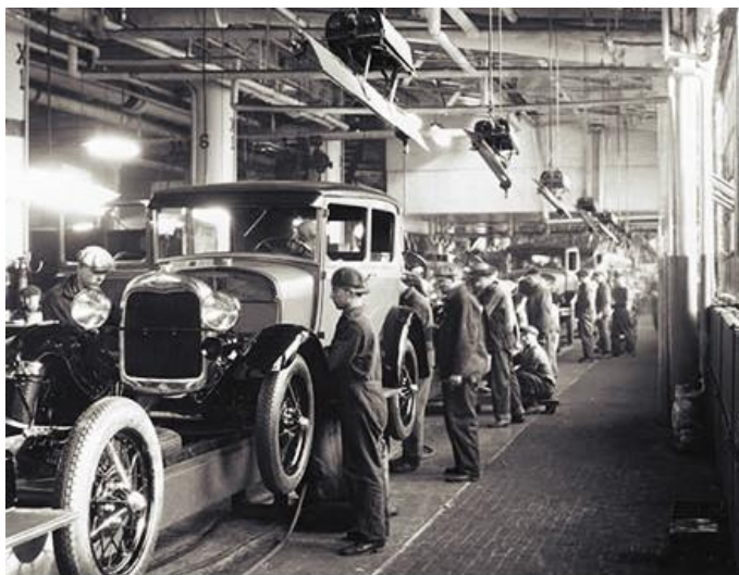
Rys. 2. Taśma montażu samochodów w fabryce Forda w 1927 roku ( http://retropress.pl/tag/ford/ ) Fig. 2. Car assembly line at the Ford factory in 1927 ( http://retropress.pl/tag/ford/ )
